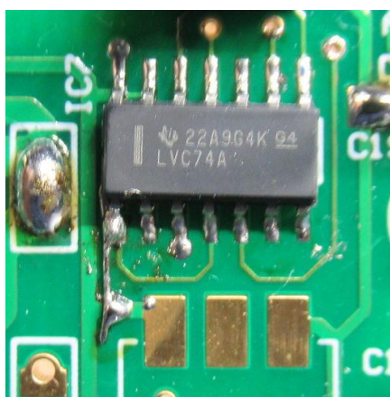
修正例（最寄りの VDD 端子に接続）
