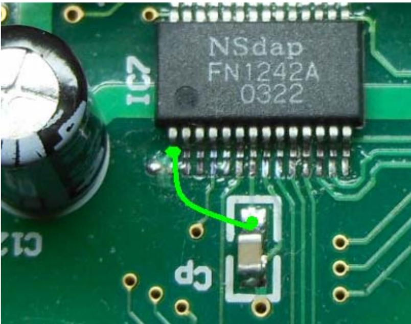
4. 緑線の部分を接続(FN1242A の PIN1 と、PIN7 と繋がっているチップコンデンサの片端)。
