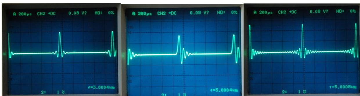
図 DAC8741 ではフィルター応答が選択可能です(パルス入力時)
