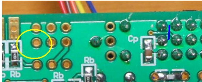
(a) 左の黄丸のランドをベタ GND へ接続。右の青線のパターンを切断
