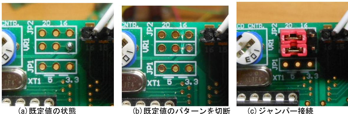
図 LCD 電源を SC2004 (20 列用) に変更する場合
