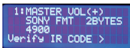
図 キーが押されるとそのフォーマットとデータバイト数が表示されます (SC2004 の場合)。 その後ベリファイのため、再度同じキーを押します。
