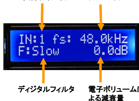
図 LCD の基本表示（シンプルファンクションモード）
