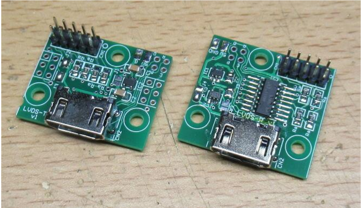
図 完成例(左 : HDMI_LVDS_T (送信)、右 : HDMI_LVDS_R (受信))
