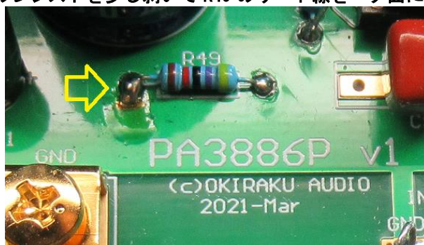
図 修正箇所（抵抗リードを部品面ベタ GND に接続）
