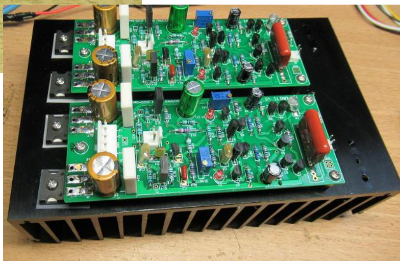
図 完成例 および放熱板への取り付け例
