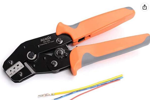
図 使用可能な圧着ペンチ例
