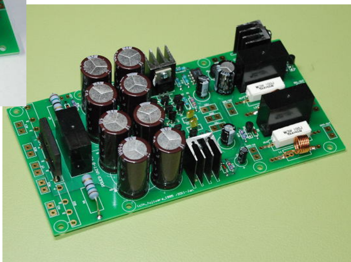
電圧増幅段用電源基板 TYPE-B
