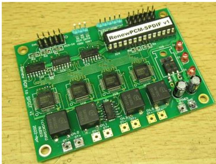
図 完成例 (4 チャンネルのフル実装した状態)
