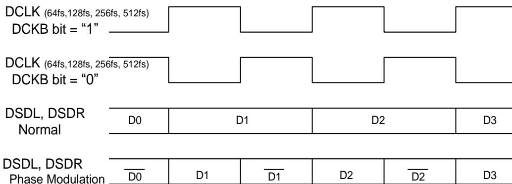
Figure 45. DSD Mode Timing
