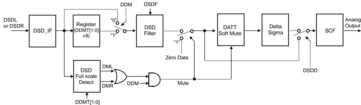
Figure 48. DSD Block Diagram
