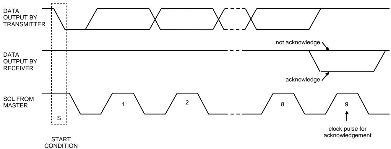
Figure 75. I<sup>2</sup>Cバスでの確認応答
