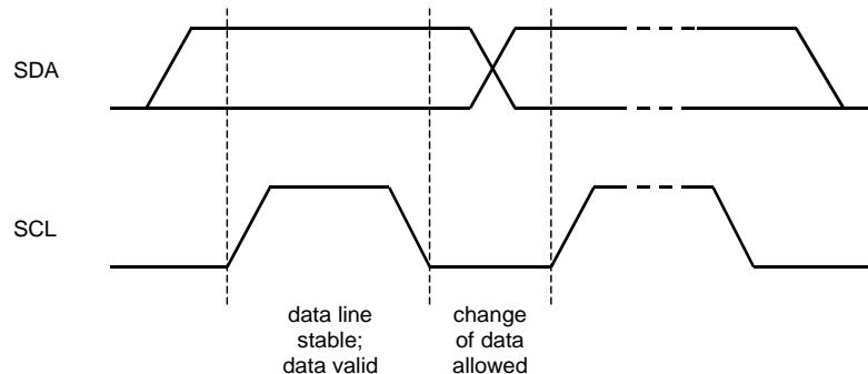
Figure 76. I<sup>2</sup>Cバスでのビット転送
