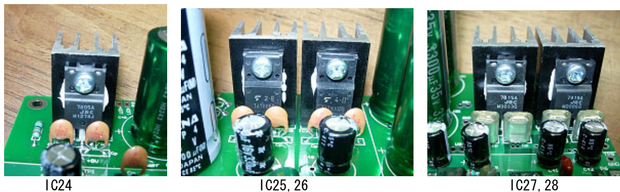
図 レギュレータの向き（型番が書いてあるほうが基板内側へ）
